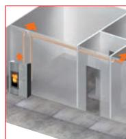
1 ventilador superior aire ambiente + 2 ventiladores posterior para canalización.
