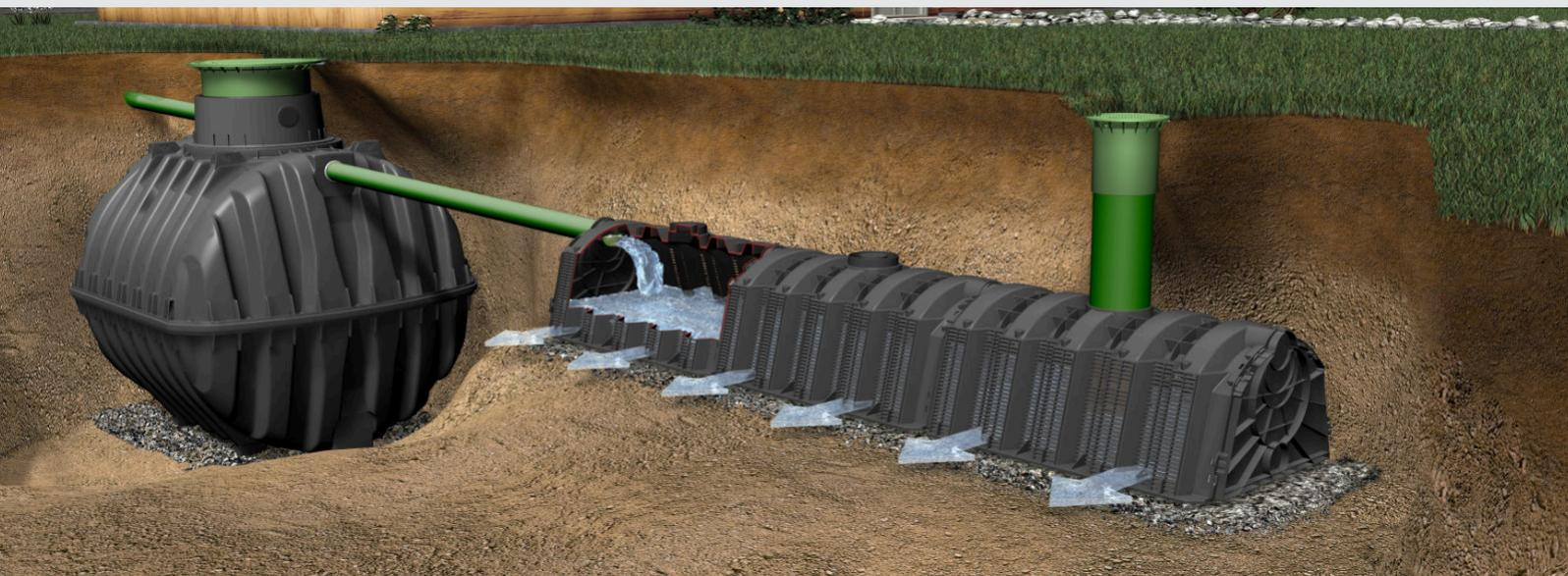
¿No hay ningún río o zona para evacuar el agua tratada cerca de tu casa? Entonces puedes infiltrar el agua tratada en el subsuelo utilizando el túnel de infiltración. Sólo necesitas un terreno suficientemente permeable a una distancia mínima de 1 m de los niveles freáticos.
