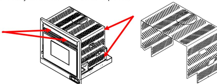
4- Una vez la zona en cuestión quede limpia deberá volver a instalar el protector metálico y desplazar el insertable a su posición inicial. En el caso de que la reinstalación no se haya hecho de forma correcta, el dispositivo de seguridad que realizó el corte de corriente en el momento de la desinstalación no reactivará la alimentación de corriente por lo que no podremos encender el equipo.
