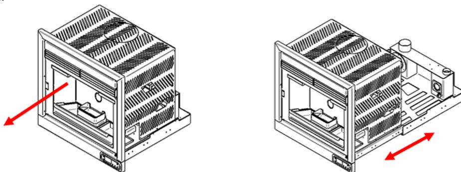
3- Deberá desatornillar el protector metálico que envuelve al equipo y sirve para que no se precipiten restos de obra, animales, etc... dentro del equipo y puedan ocasionar cualquier tipo de daños. Dicho elemento posee dos tornillos en su parte superior y otros dos a ambos lados del mismo. Una vez desatornillado usted lo podrá desmontar y así acceder a las zonas requeridas.
