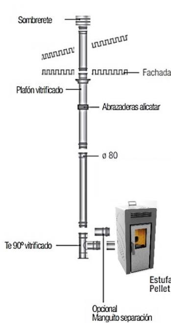
**SALIDA VERTICAL CON TUBERÍA SIMPLE A DOBLE PARED**
