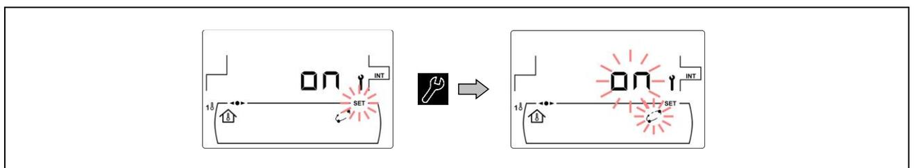
4. En caso de haber seleccionado la función de **emparejamiento**, ésta se deberá realizar desde el propio dispositivo inalámbrico. Dependiendo del tipo de dispositivo inalámbrico (**Confort iC** o **Sonda iC**) el emparejamiento se realizará de forma diferente (ver el manual de instrucciones suministrado con cada dispositivo para obtener más detalles):
