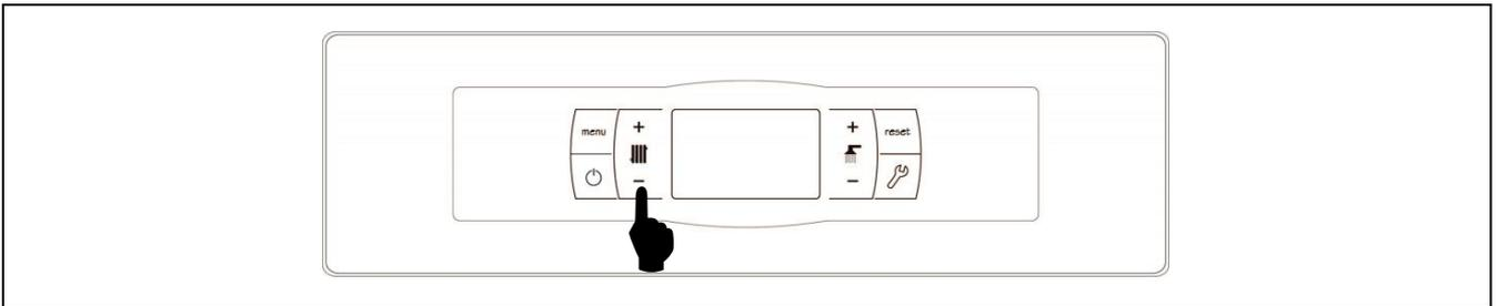
La selección de la temperatura deseada en el depósito de inercia se realiza mediante el selector táctil indicado en la figura. Para seleccionar la temperatura deseada tocar en los símbolos "+" o "-" para incrementar o disminuir el valor de la temperatura, respectivamente. Una vez seleccionada la temperatura, en unos pocos segundos la pantalla regresará a la situación de reposo. El rango de consigna de temperatura seleccionable es de OFF, 30 - 80 °C.
