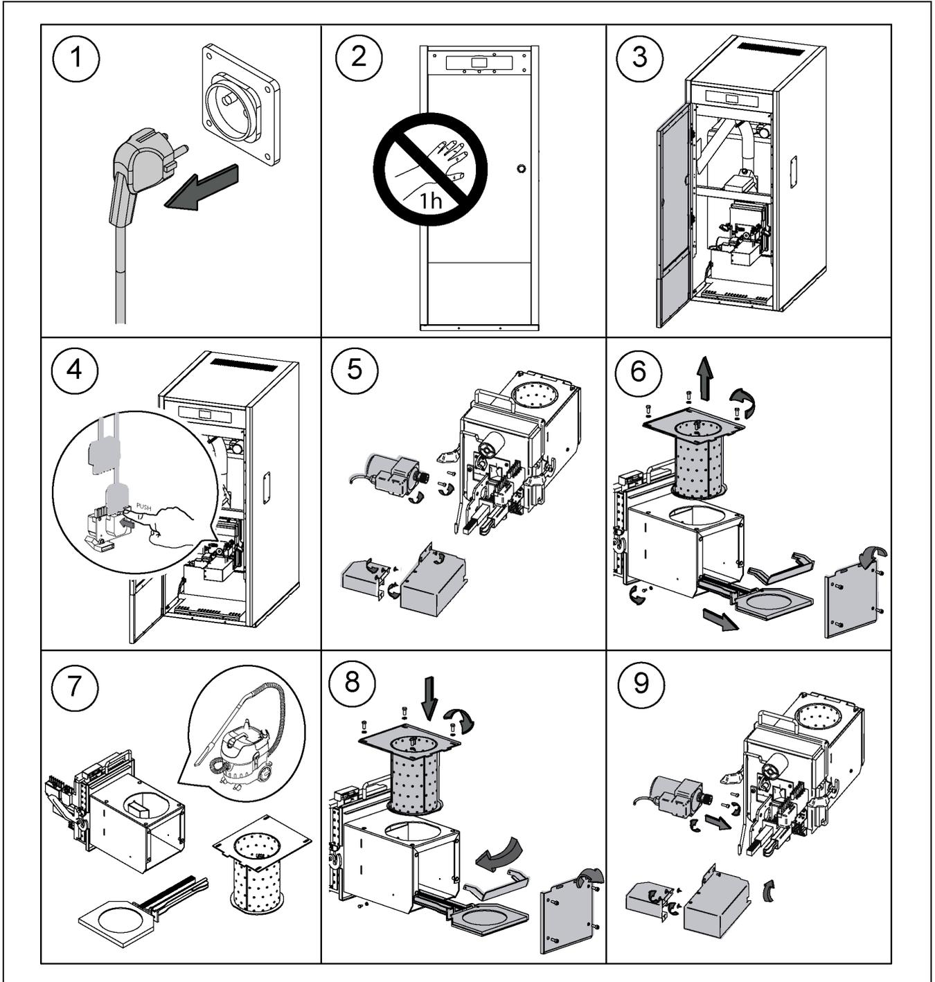
Dependiendo de la cantidad de pellets de madera quemados o de su calidad, el usuario debe limpiar las paredes del quemador utilizando un cepillo adecuado, para evitar una formación demasiado grande de ceniza.
