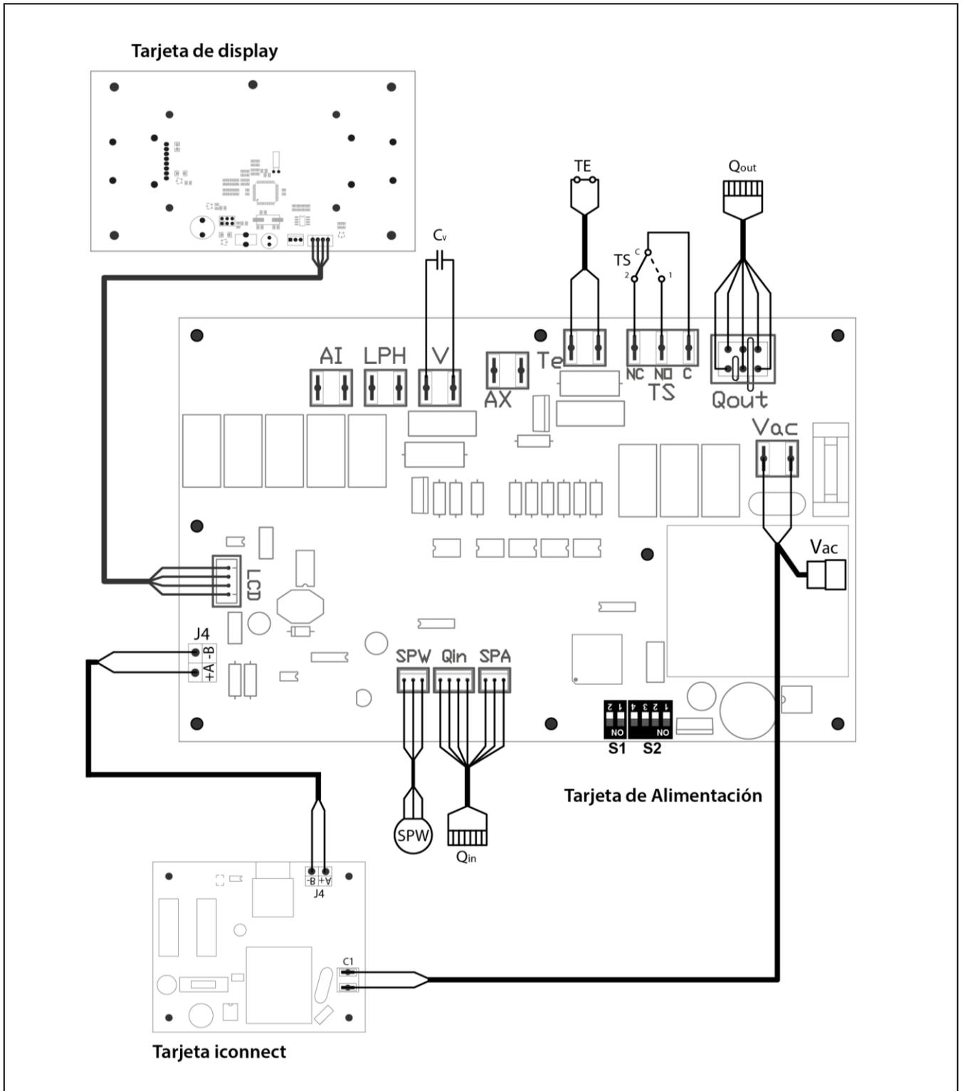
**TS:** Termostato de seguridad.
