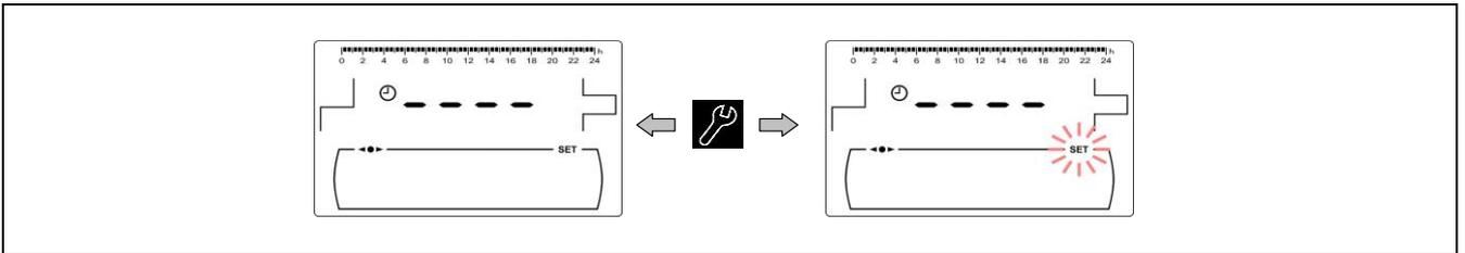
Mediante los símbolos "+" o "-" de Calefacción (18) se navegará a través de la horas de programación en saltos de 30 minutos.
