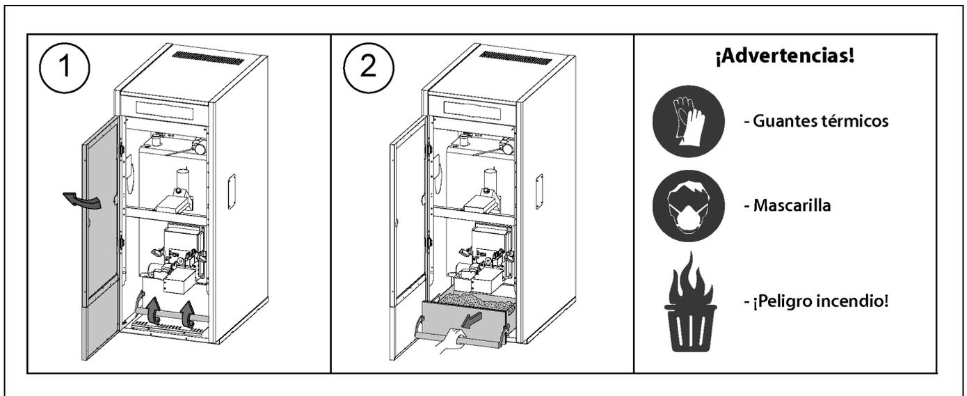
El usuario debe asegurarse regularmente del buen vaciado del cenicero, y comprobar en la pantalla de la caldera su nivel de llenado.
