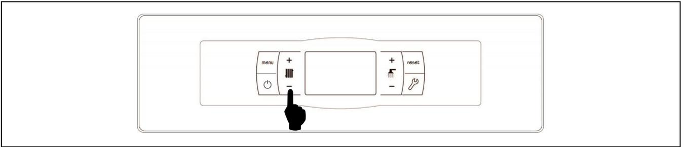
La selección de la temperatura deseada de funcionamiento de la caldera se realiza mediante el selector táctil indicado en la figura. Para seleccionar la temperatura deseada tocar en los símbolos "+" o "-" para incrementar o disminuir el valor de la temperatura, respectivamente. Una vez seleccionada la temperatura, en unos pocos segundos la pantalla regresará a la situación de reposo. El rango de consigna de temperatura de caldera seleccionable es de OFF, 65 - 80 °C.
