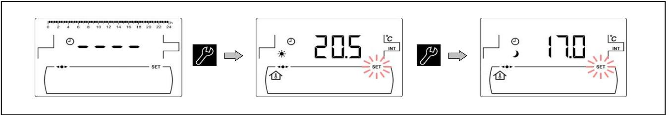
Para el resto de las programaciones horarias se accederá directamente al proceso de ajuste de los periodos temporales de activación y desactivación de la función seleccionada:
