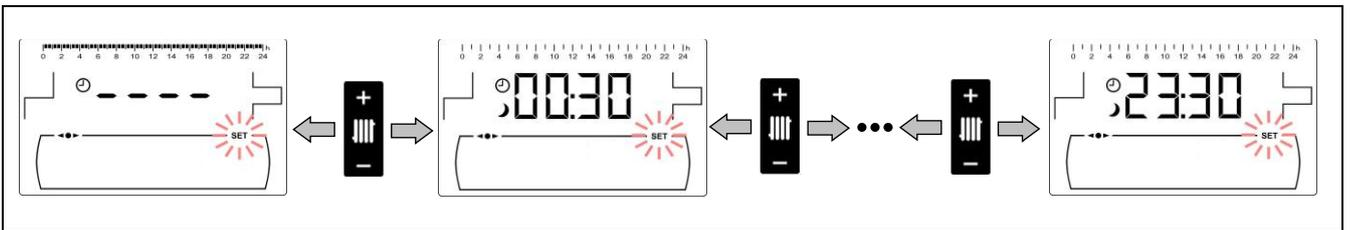
Una vez seleccionada el periodo horario deseado, mediante los símbolos "+" o "-" de ACS (19) se modificará el estado de programación de dicho periodo, de "apagado", visualizándose el símbolo 🌙, a "encendido", visualizándose el símbolo ☀️ y viceversa.
